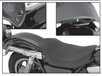
**CAUTION:** IN ALL TRIAL FITS, MAKE SURE THE SEAT IS POSITIONED ALL THE WAY FORWARD AND PLACED ON THE BIKE CORRECTLY.
